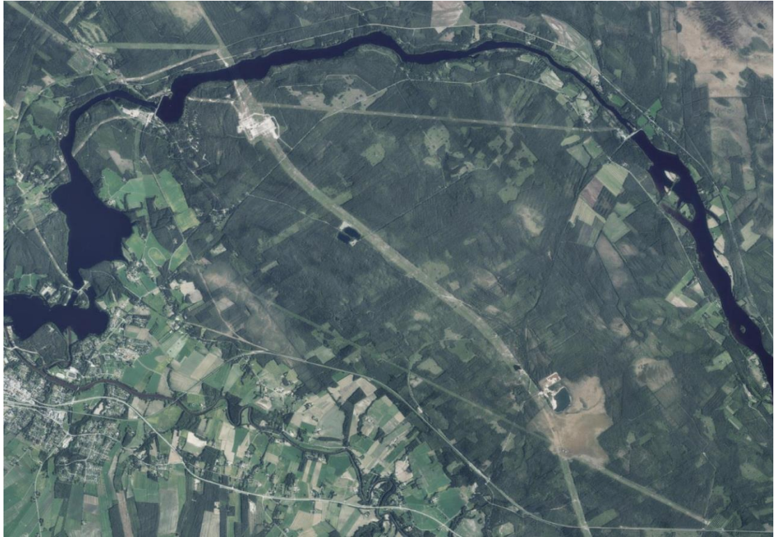
Kuva 4. Ilmakuvapari. Ilmakuva vuodelta 2022 (Paikkatietoikkuna/MLL ilmakuva-arkisto 10.10.2024). Padottu joki erottuu kuvassa aiempaa laajempina vesialueina. Pyhänselän sähköasema ja sinne johtava leveä johtoaukea reunavyöhykkeineen on yksi alueen hallitsevista piirteistä. Alueella on lisäksi kaksi muuta hieman kapeampaa johtoaukeaa. Ilmakuvassa erottuvat myös entiset maa-ainesten ottoalueet/louhosalueet sekä lähialueen ainoa ojittamaton suoalue (Kapustasuo).
